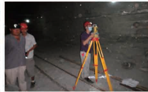
项目名称：邳州石膏矿 工作内容：地质环境调查评价项目 石膏矿井下测量
