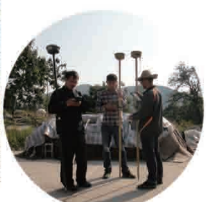
工作内容：测量工作前的仪器及控制点校正 工作人员：梁连柱 尹德宣 翟如伟
