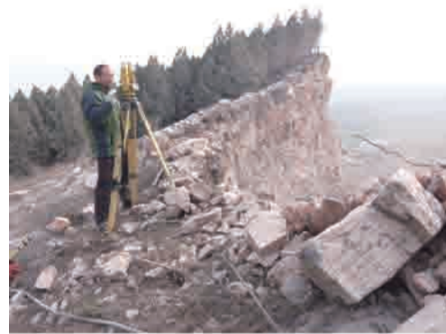
项目名称：徐州铜山区露天矿山监理 工作内容：在山顶复杂地形条件架设全站仪进行野外测量 工作人员：曹强
